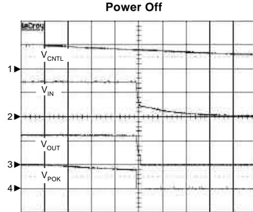
$C_{OUT}=10\mu F$ ,  $C_{IN}=10\mu F$ ,  $R_L=0.6\Omega$
