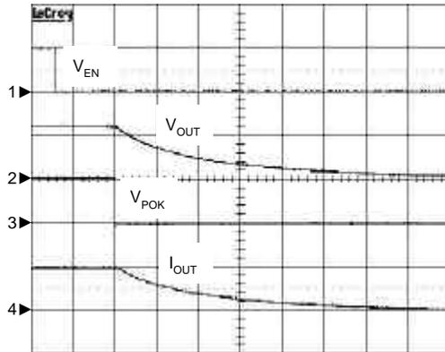
$C_{OUT}=10\mu F$ ,  $C_{IN}=10\mu F$ ,  $R_L=0.6\Omega$
