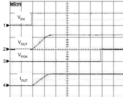
$C_{OUT}=10\mu F$ ,  $C_{IN}=10\mu F$ ,  $R_L=0.6\Omega$
