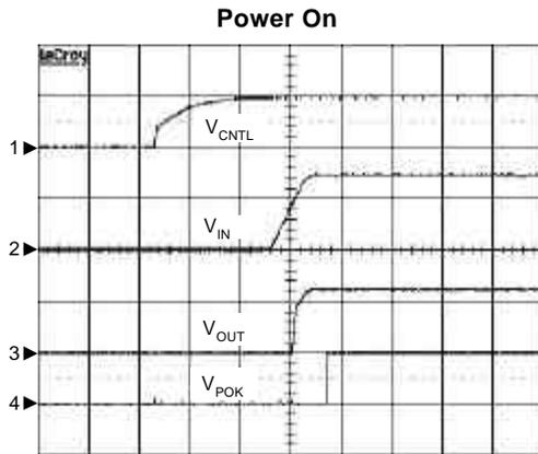
$C_{OUT}=10\mu F$ ,  $C_{IN}=10\mu F$ ,  $R_L=0.6\Omega$
