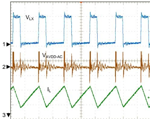
$V_{IN}=3.3V$ ,  $V_{AVDD}=9.5V/300mA$ ,  $L=2.2\mu H$
