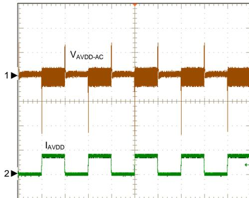
$V_{IN}=3.3V$ ,  $V_{AVDD}=9.5V$ ,  $L=2.2\mu H$
