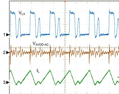
$V_{IN}=3.3V$ ,  $V_{AVDD}=9.5V/50mA$ ,  $L=2.2\mu H$
